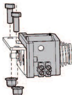
Verrou électro-mécanique pour SLIDEMATIC
